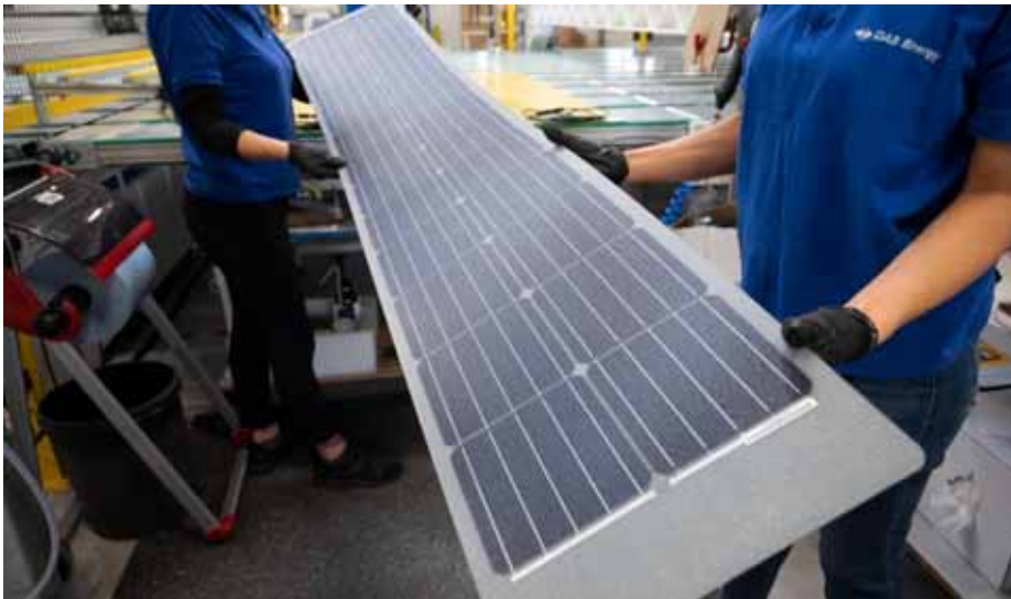
Links: Leichtbaumodul mit 3,3 \text{ kg/m}^2 , rechts: Montage (© DAS Energy)
