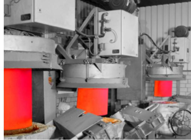
Abbildung 11: Porenbrenner zur Pfannenvorwärmung.
