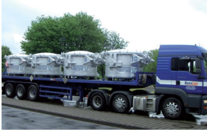
Abbildung 7: Lkw-Transport von Flüssigaluminium. Quelle: TRIMET Aluminium SE
