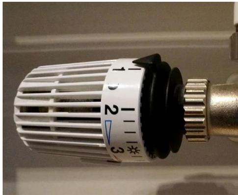
Das **Standard-Thermostatventil besteht aus zwei Teilen**: Im Unterteil sitzt das Ventil, der sichtbare Teil ist der sogenannte Thermostatkopf. Er beherbergt das Herzstück des Thermostatventils: den **mit Wachs, Gummi, Flüssigkeit oder Gas gefüllten Temperaturfühler** (auch Aktor beziehungsweise Dehnstoffelement genannt). Mit dessen Hilfe steuert man das Öffnen und Schließen des Ventils, also den Durchflussquerschnitt des Heizungsvorlaufs und damit die Durchflussmenge.
